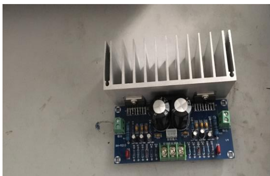
照片12 放大电路实物图
