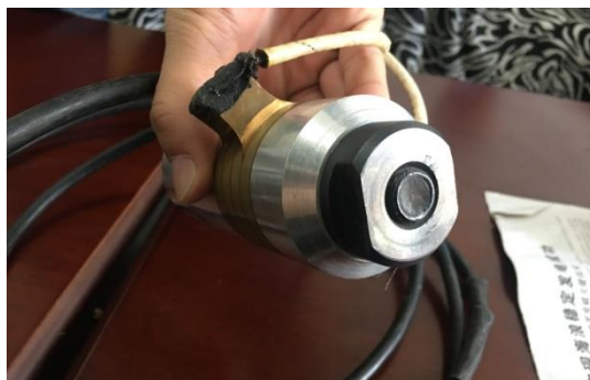
照片 10 通过选型接线得到的超声换能器
