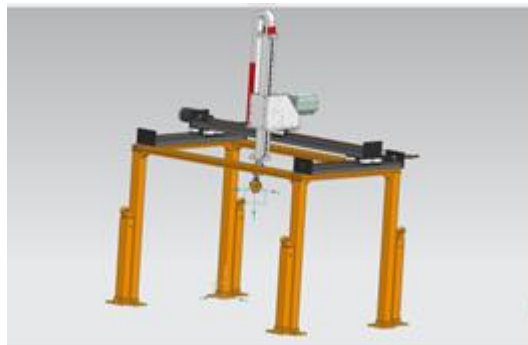
照片6 桁架式机械臂整体结构
