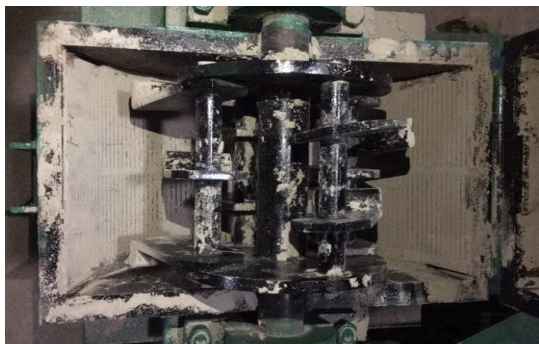
照片 11 试验室中正在工作的锤式粉碎机
