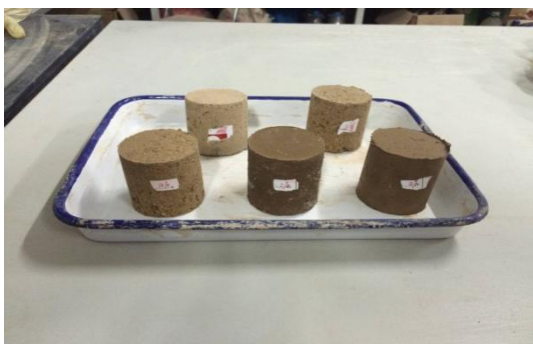
照片 19 制备好的土柱样品
