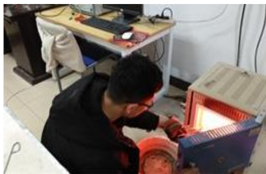
照片 17 郝天军从炉中取出样品进行水淬
