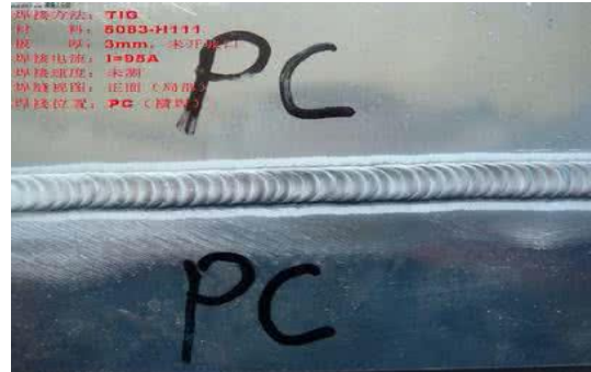
图 20 TIG 焊焊接到的焊缝
