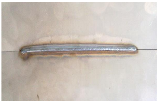
图 19 MIG 焊焊接到的焊缝
