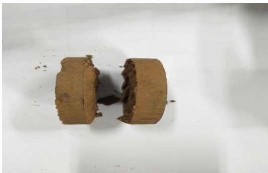
照片5 直剪试验后破坏的图样
