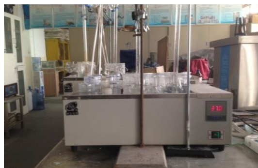
照片 4 失重实验装置
