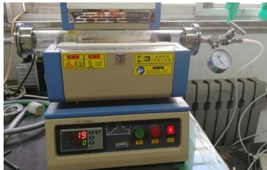
图10 实验仪器管式炉
