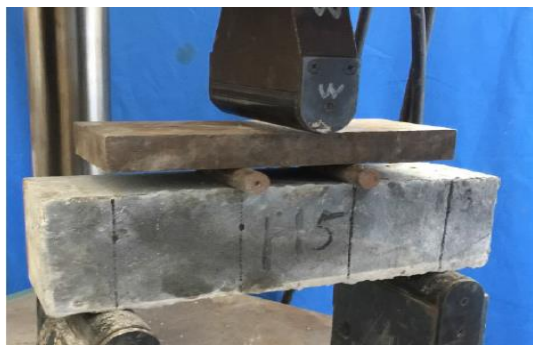
图3 四点抗折试验装置
