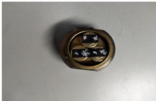
照片16 扫描电镜的样品放置
