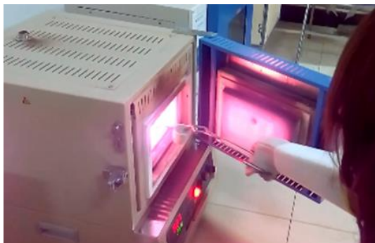
照片 2 不锈钢固溶处理
