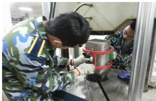
照片 12 混凝土弹性模量测试
