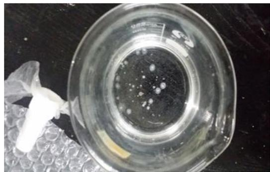
照片 14 UV 固化胶的亲疏水性的检测
