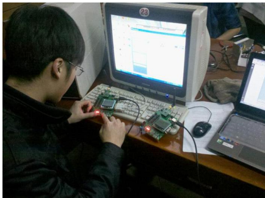
照片 10 两个 Zigbee 模块之间进行通信(许京)
