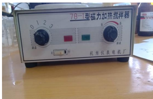
照片2 实验过程所用的加热搅拌器
