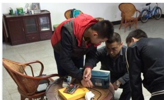
图8 指导老师用数据分析仪采集传感器输出信号
