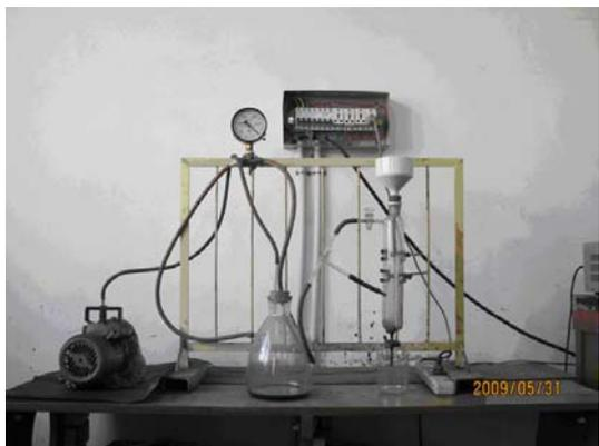
照片6 实验过滤装置
