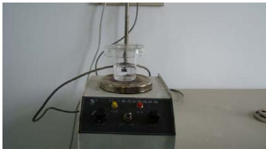
照片 7 磁力加热搅拌器
