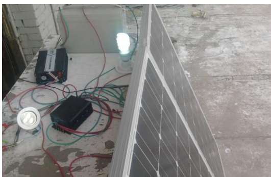
照片4 普通太阳能系统的板面温度与工作电压、电流、功率等数值的测定
