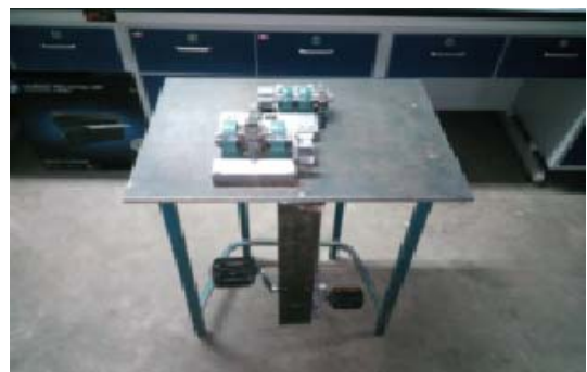
图5 层结合强度测试装置
