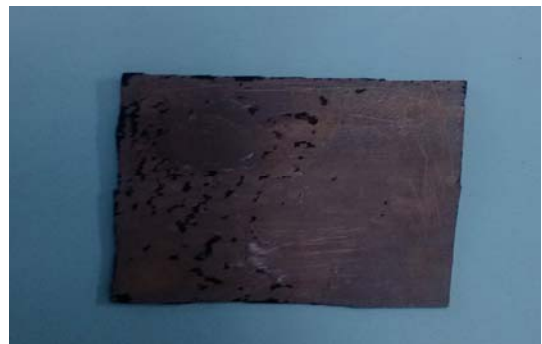
图6 涂层得到去除的报废镁合金
