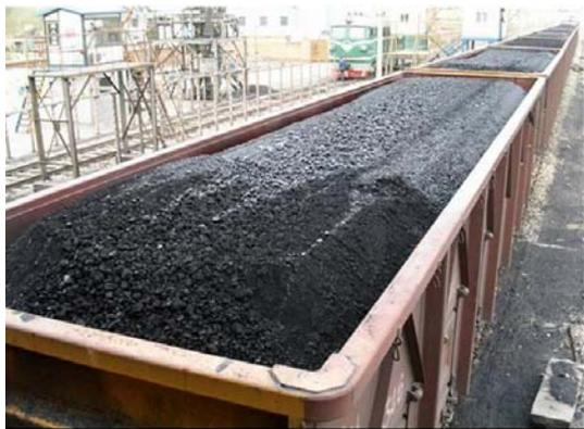
照片 10 运煤车表面喷洒和未喷洒效果对比
