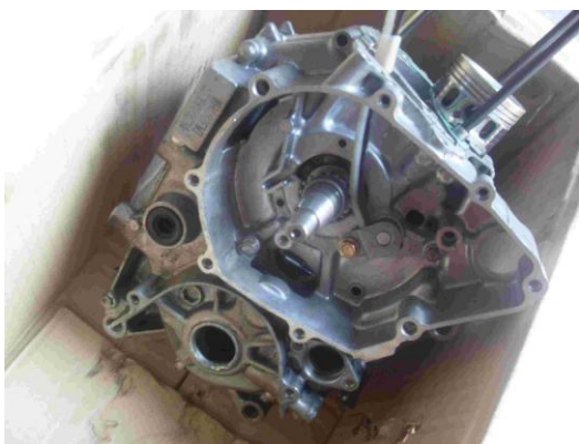
照片7 拆解的旧发动机内部构造
