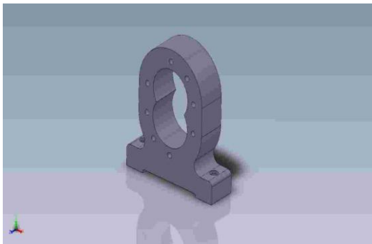
照片6 齿轮泵中间泵体三维设计图
