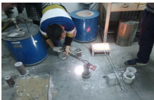
照片2 合金浇注实验
