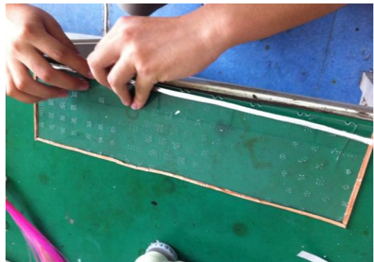
照片 1 正在修整的导光板
