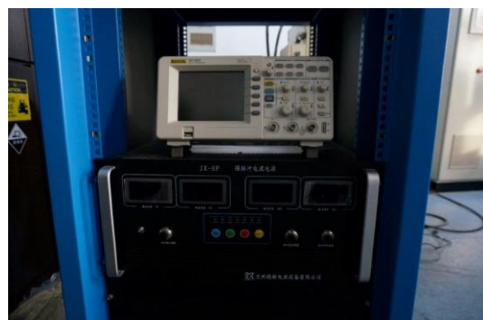
照片 11 实验用电脉冲电源及示波器
