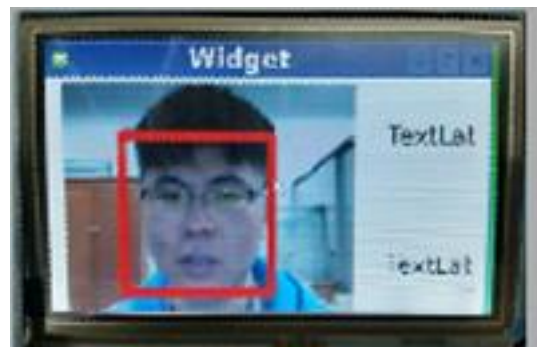
照片 1 ARM9 平台对图像进行采集并动态显示 (李鑫)
