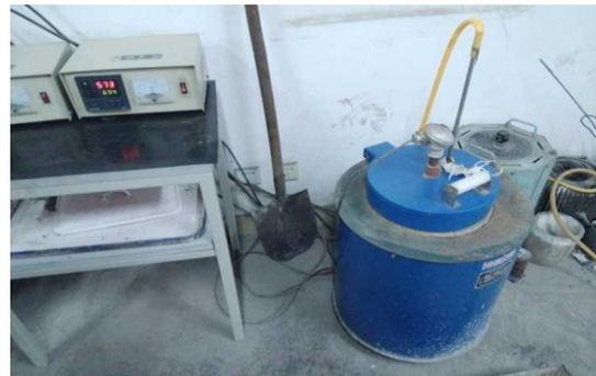
照片3 熔炼炉
