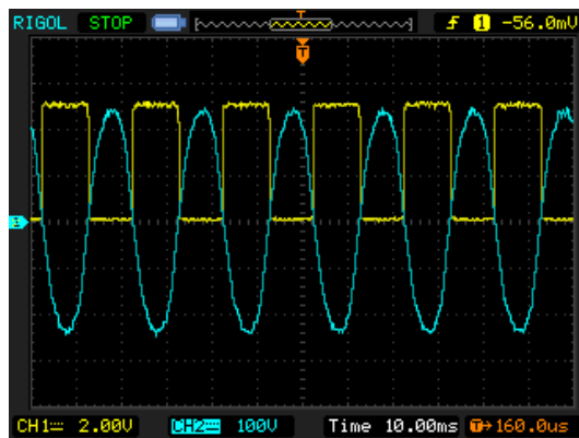
照片 7 过零检测电路测试波形图
