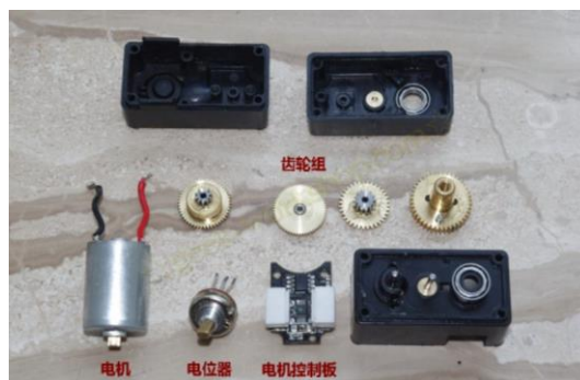
照片1 舵机内部结构图
